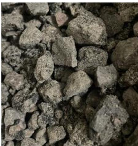
Рисунок 8 – Регенерированное асфальтовое покрытие (РАП)
