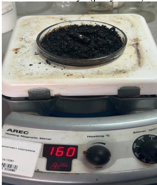
Рисунок 9 – Проведение смешивания РАП и модификатора
